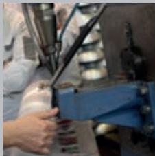
La pressa stampa il disco che assume, in una versione grezza, la forma voluta. Successivamente si effettua la rifinitura per eliminare le imperfezioni e la pulitura che gli conferisce l'aspetto definitivo. Per le pentole in acciaio è necessaria una ulteriore fase di lavorazione detta lucidatura, per conferire al metallo la sua tipica brillantezza.
